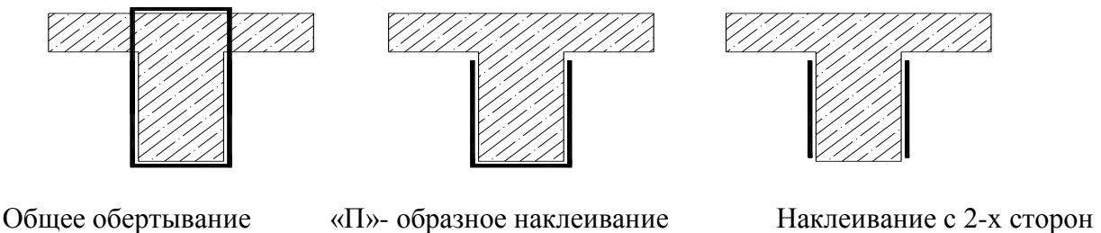
Рис. 6.2.7. Схемы усиления СВА наклонных сечений изгибаемых элементов
