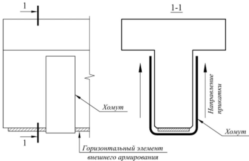
Рис. 7.3. Схема установки вертикальных хомутов в балочных конструкциях
