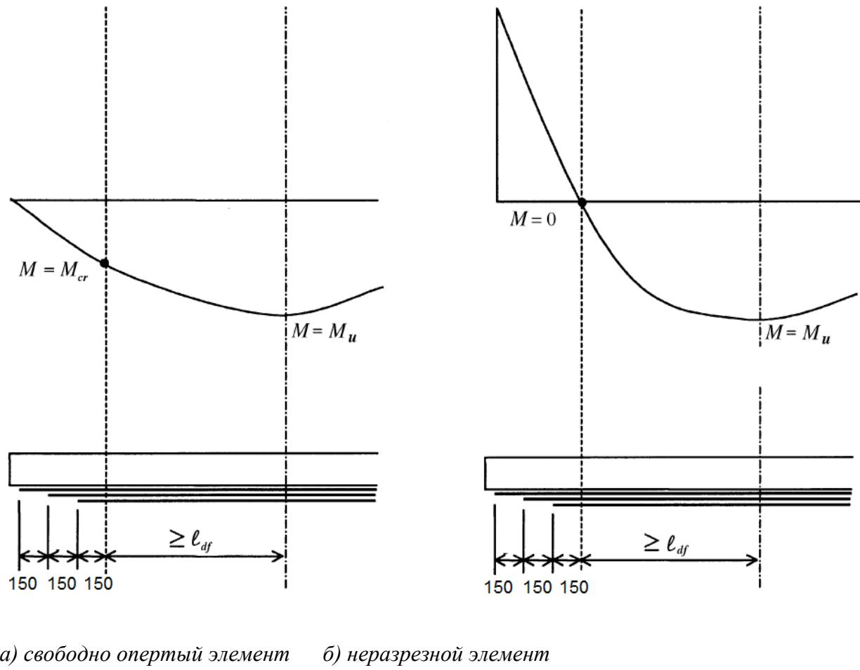
Рис. 7.2. Усиление растянутой зоны элемента
