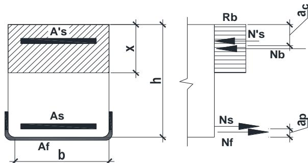
Рис. 6.2.2. Расчетная схема усиливаемого сечения с загибом ленты на боковые поверхности балок
