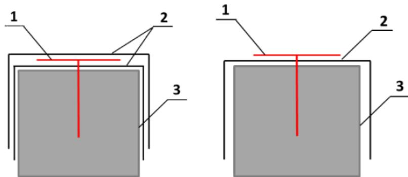
Рис. 7.9. Схемы установки углеродных анкеров в системе внешнего армирования.
