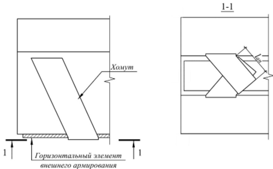
Рис. 7.4. Схема установки наклонных хомутов в балочных конструкциях
