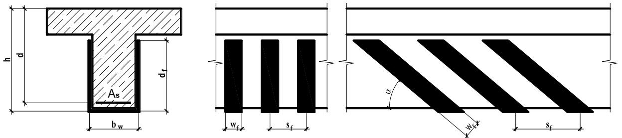
Рис. 6.2.8. Размещение СВА хомутов для усиления наклонных сечений
