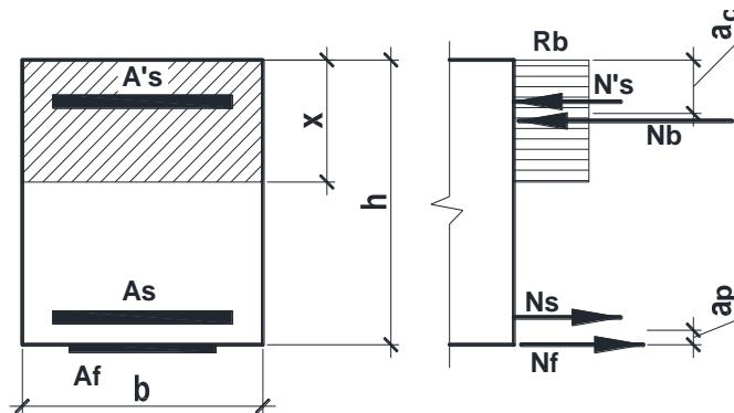
Рис. 6.2.1. Расчетная схема усиливающего сечения
