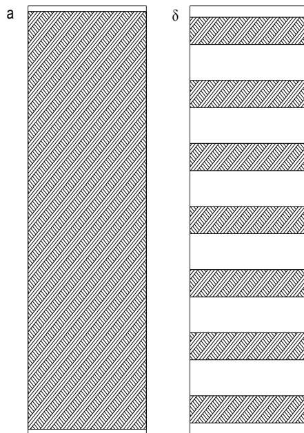
Рис. 7.8. Способы усиления колонн обоймами
