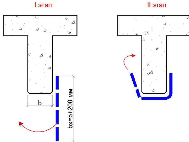
Рис. 7.5. Схема установки лент на балочные конструкции
